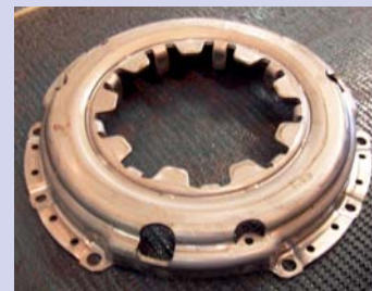
Drie persen vormen plaatmateriaal op rollen in hoog tempo om in drukgroepdeksels en andere koppelingsdelen.
