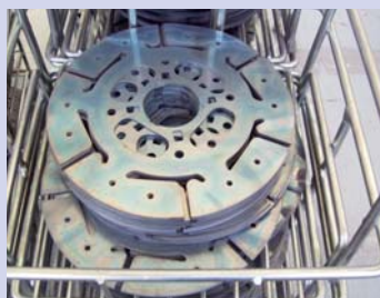
Voor zacht aangrijpen buigt een pers de 'schiereilandjes' van de koppelingsplaat iets op bij 650°C. Het frictiemateriaal komt uit een andere Valeo-fabriek.
